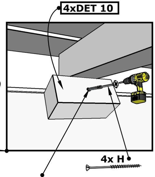
Bitte bohren Sie  $\text{\O}4\text{mm}$  Löcher vor dem festschrauben
